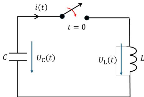
Nous voulons déterminer le courant  $i(t)$  et la tension  $U(t) = U_C(t) = U_L(t)$  pour  $t = 0$
