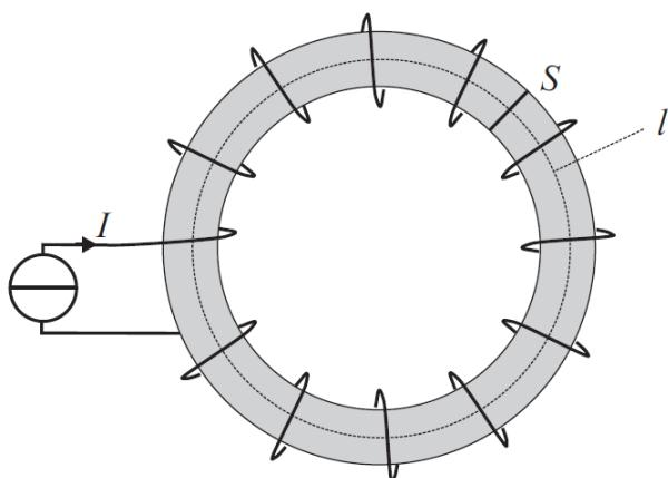
Dans la figure ci-dessus, un fil est enroulé ( $N = 1000$  spires) sur un noyau diélectrique ( $\epsilon_r = 1$ ), de longueur moyenne  $l = 200 \text{ mm}$ . Chaque spire a une surface  $S = 175 \text{ mm}^2$ .
